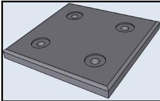
Le FAB'LORN m'a permis de créer des blocs avec une imprimante 3D, ils serviront à fabriquer des moules en plâtre pour y fondre du plastique HDPE.
